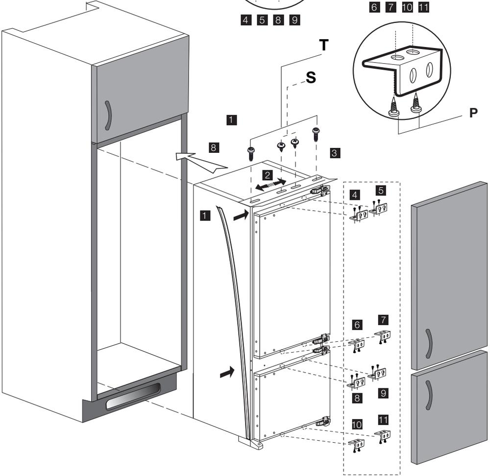
**Not:** 2-3 numara ile gösterilen montaj adımımda üst bağlantı plastiğini kaydırabilmek için bağlantının yapıldığı vidaları tam sıkmayınız.
