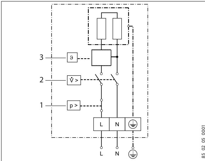
1 Предохранительный ограничитель давления
